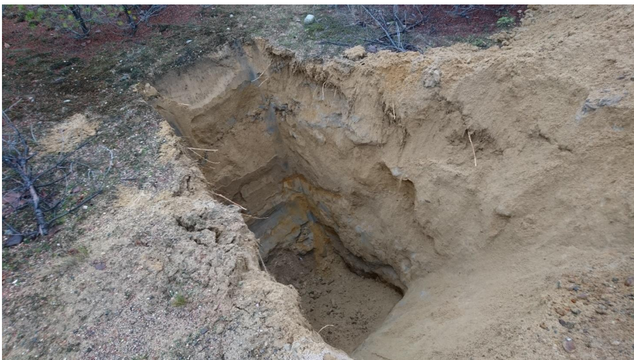
Kuva 3. KK5. Perusmaa alueella on hiekkaa ja soraa, mutta myös ohuita hienorakeisempia kerroksia esiintyy.
